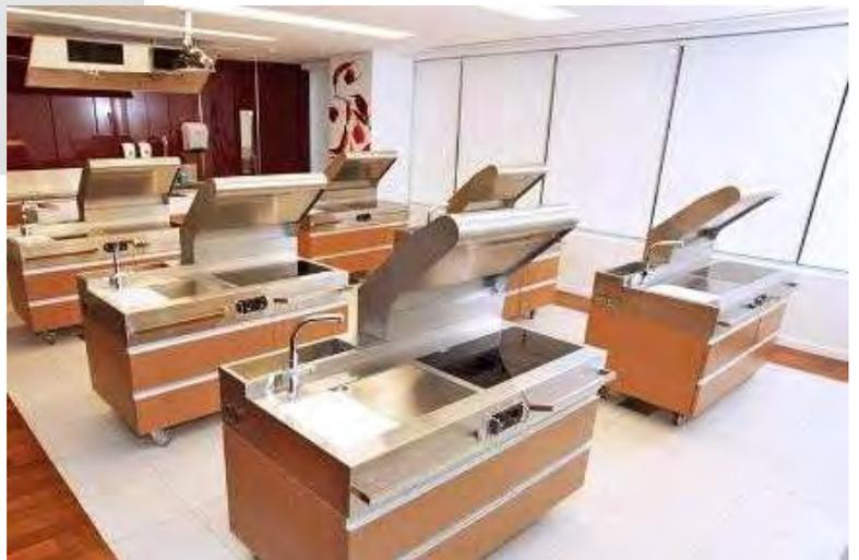
Coifa auto dissipadora de odores “sem duto”, com exaustor que capta o ar pesado da cortina de ar, removendo as emissões de vapores e gorduras, com sua tubulação interna. Não transmite calor ao ambiente da cozinha e reduz o risco de acidentes por queimaduras. Além disso, possui caixa de circulação em cada lado, separada, triplicador de vazão, ionizadora e filtragem primária.
