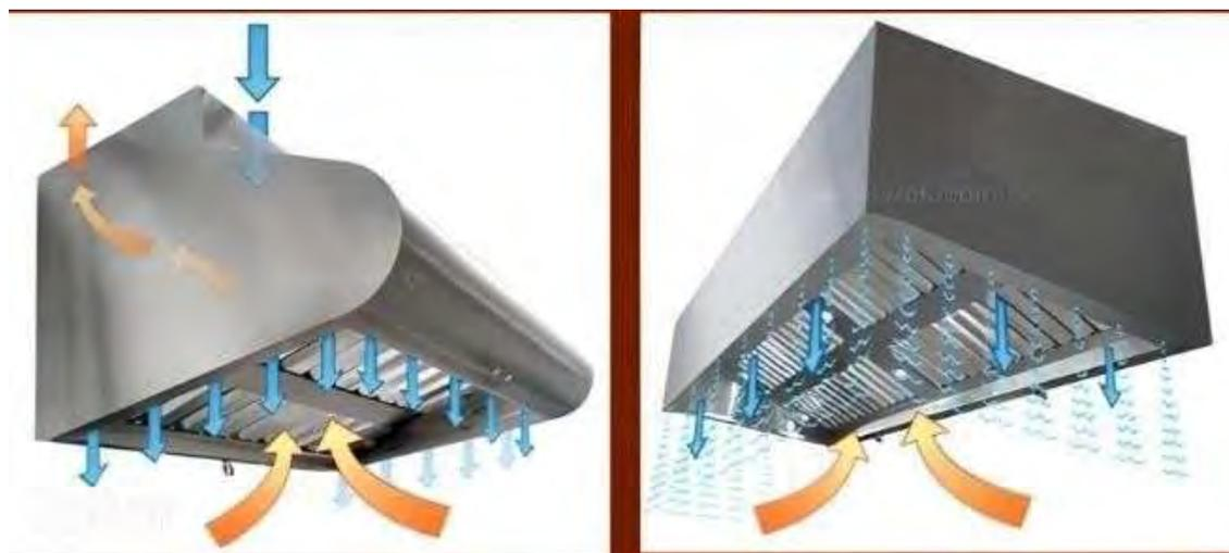
Além do sistema de tratamento de odores a coifa ARWEK conta com o sistema auto compensado opcional, que permite a transferência segura de ar do ambiente interno ou externo para a coifa de sua churrasqueira sem a ocorrência de perda de pressão e formando uma cortina de ar pelas suas extremidades adjacentes evitando a saída dos poluentes contidos do ar que o processo de cocção libera.
