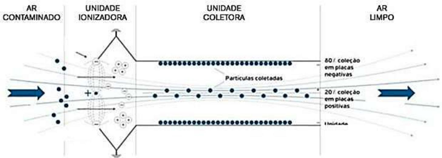
Coifa Ilha com sistema exclusivo Eletrostático eliminador de fumaça e odor através da ozonização do ar. Não requer saída externa ou carvão ativado para remoção de odores. Por não necessitar de saída externa, pode ser instalado até mesmo embaixo de áreas restritas.
